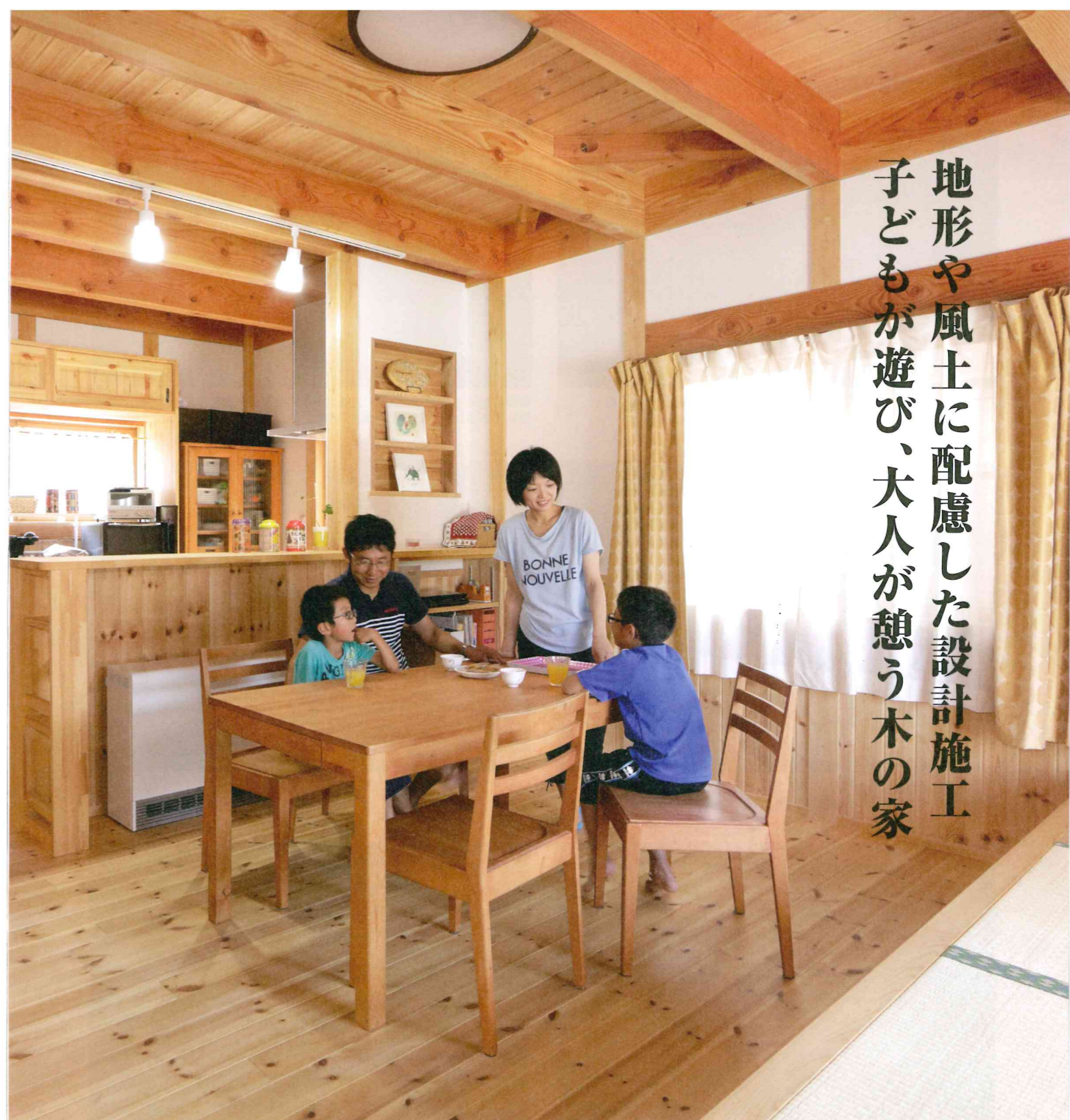
天井や梁(はり)、床などにふんだんにバインを使ったダイニング。壁は珪藻土。8寸(24cm角)もの大黒柱が力強く家族を見守る。木目の美しい部分が表に見えるよう吟味して施工
