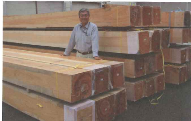
岐阜県や長野県産の良質のヒノキを大量に仕入れ、自社倉庫で長期自然乾燥。強さとともに揺れを受け止めるしなりも生まれる
