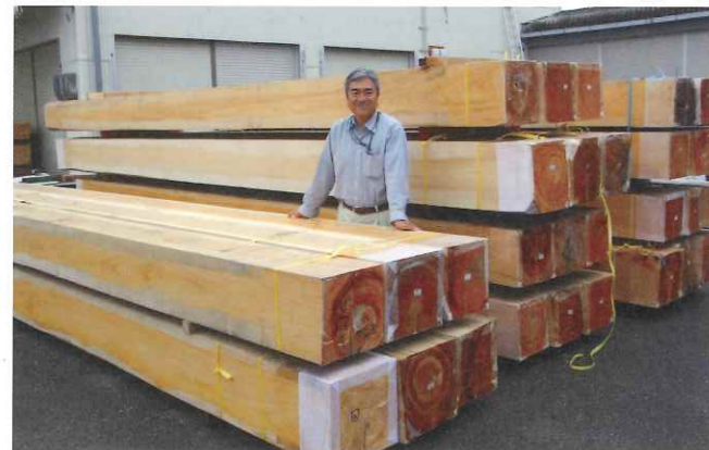
岐阜県や長野県産の良質ヒノキを大量に仕入れ、自社倉庫で長期自然乾燥。強さとともに揺れを受け止めるしなりも生まれる
